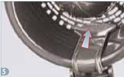
5 Sett kjeglen på motorspindelen. Plasser den dekkende armen på motsatt side i forhold til låsepunktet og fest flappen i bunnen av kurven.
