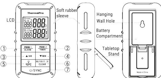
**LCD (Liquid Crystal Display)** – Visar iconer, temperatur och tid.
