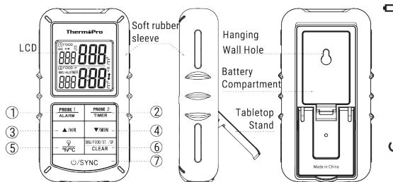
**LCD (Liquid Crystal Display) – Näyttää kaikki kuvakeet, lämpötilan ja ajan.**
