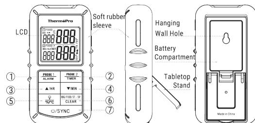
**LCD (Liquid Crystal Display) – Viser alle ikoner, temperatur og tid.**
